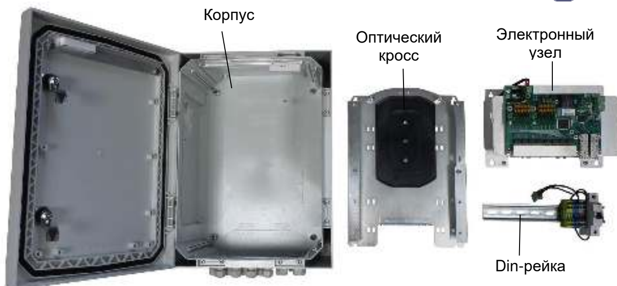
Рисунок 3.1.3 – Основные элементы коммутатора
