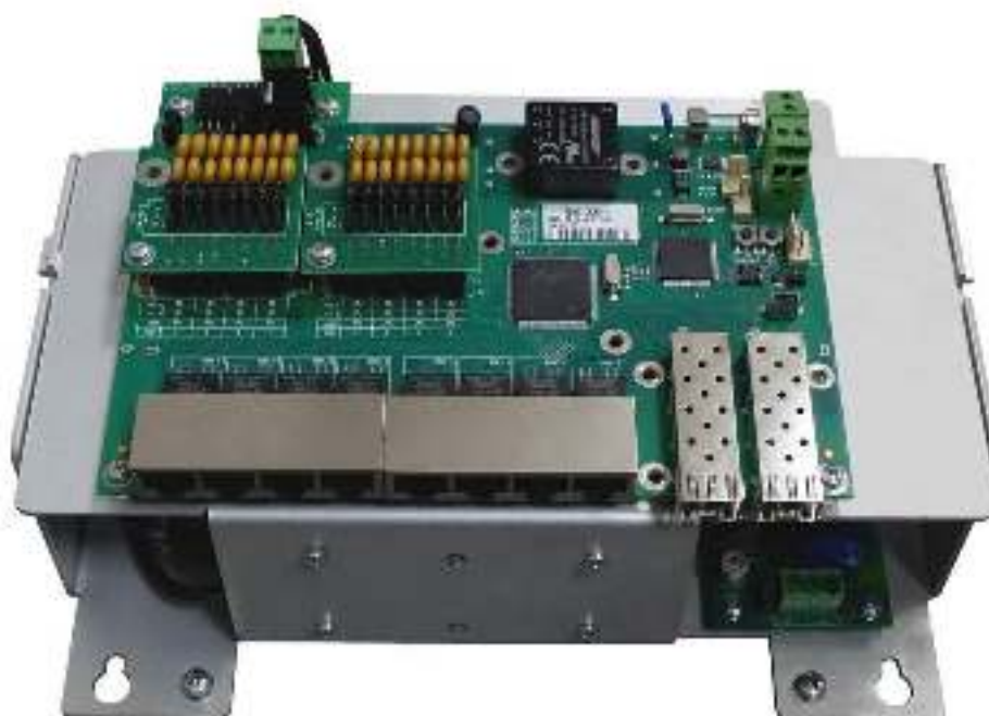
Рисунок 3.4.1 - Плата коммутатора и блоков питания
