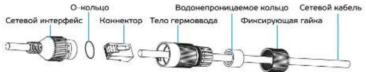
Рисунок 6. Установка гермоввода
