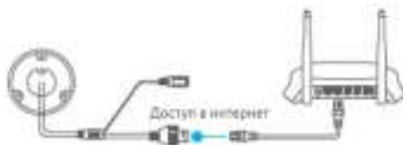
Рисунок 5-3 Подключение к роутеру
