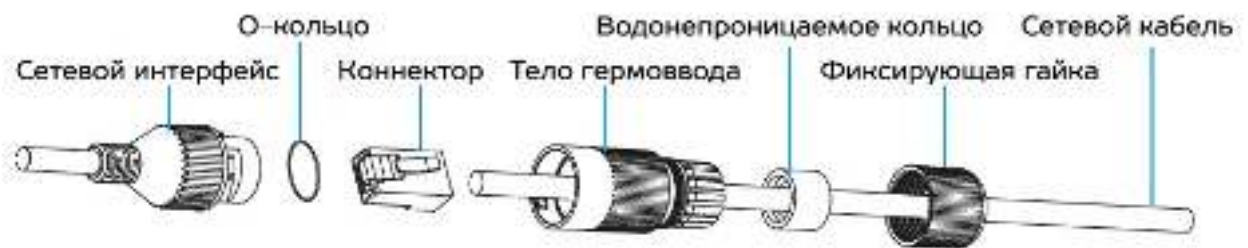
Рисунок 6. Установка гермоввода
