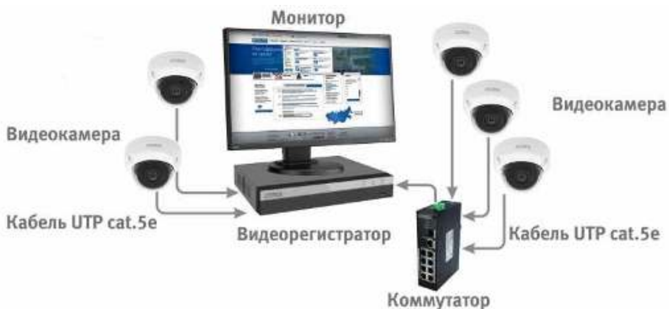
Рисунок 6.4 – Схема подключения видеокамеры к видеорегистратору
