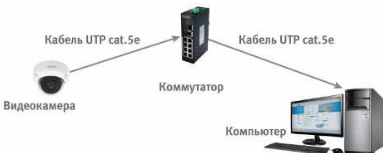
Рисунок 6.3 - Схема подключения видеокамеры к компьютеру через коммутатор
