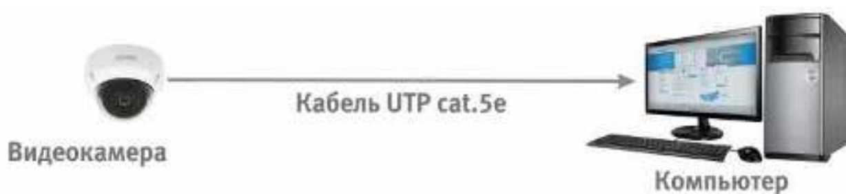
Рисунок 6.2 – Схема подключения видеокамеры к компьютеру
