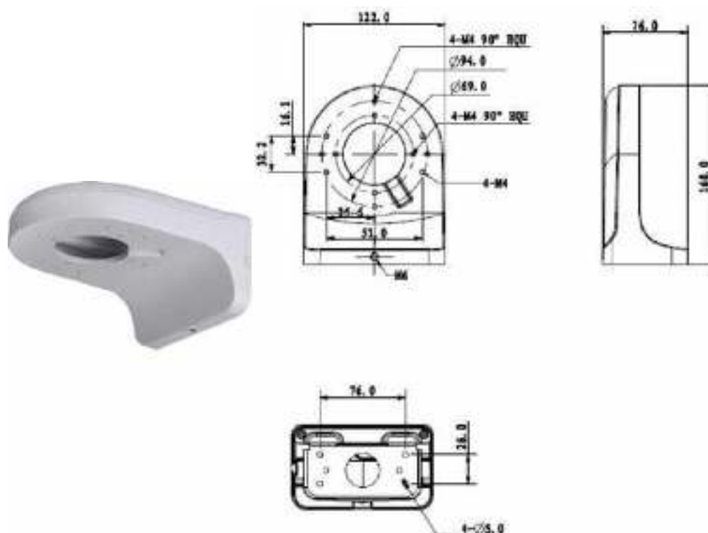
Рисунок 5.4 - Внешний вид и габаритные размеры кронштейна BR-106
