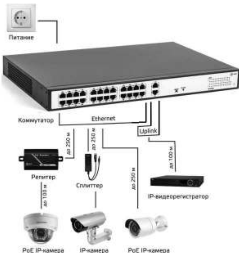
Рисунок 3 – Общая схема подключения устройств к коммутатору
