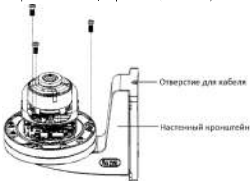
Рисунок 2-11 Установка камеры на настенный кронштейн
