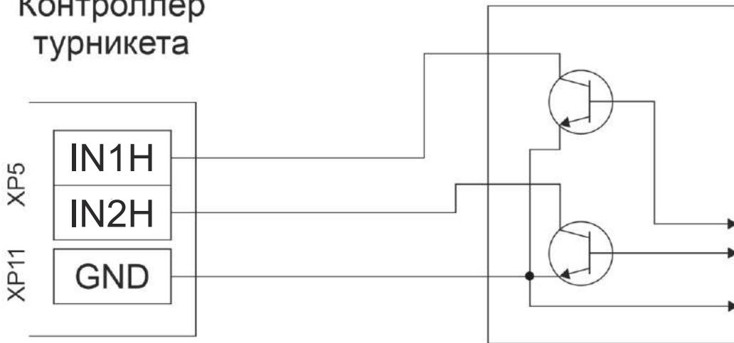
Рисунок 8.2.2 Схема подключения турникета к СКУД «открытый коллектор»
