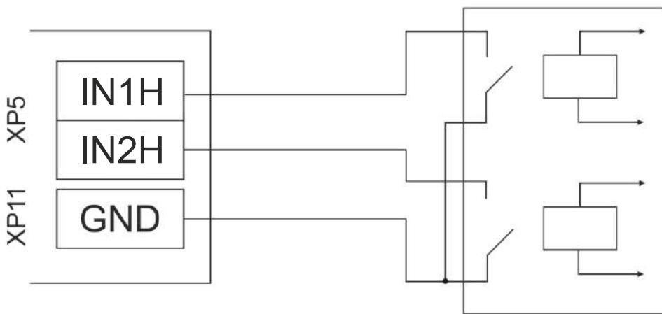
Рисунок 8.2.2 Схема подключения турникета к СКУД «сухой контакт»
