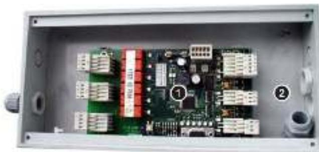
Габаритные размеры платы расширения (1) 220x110x45 мм. Возможно размещение как внутри турникета, так и вне его. При размещении ее снаружи, рекомендуется установка ее в корпус (2) с габаритными размерами 270x130x50 мм.
