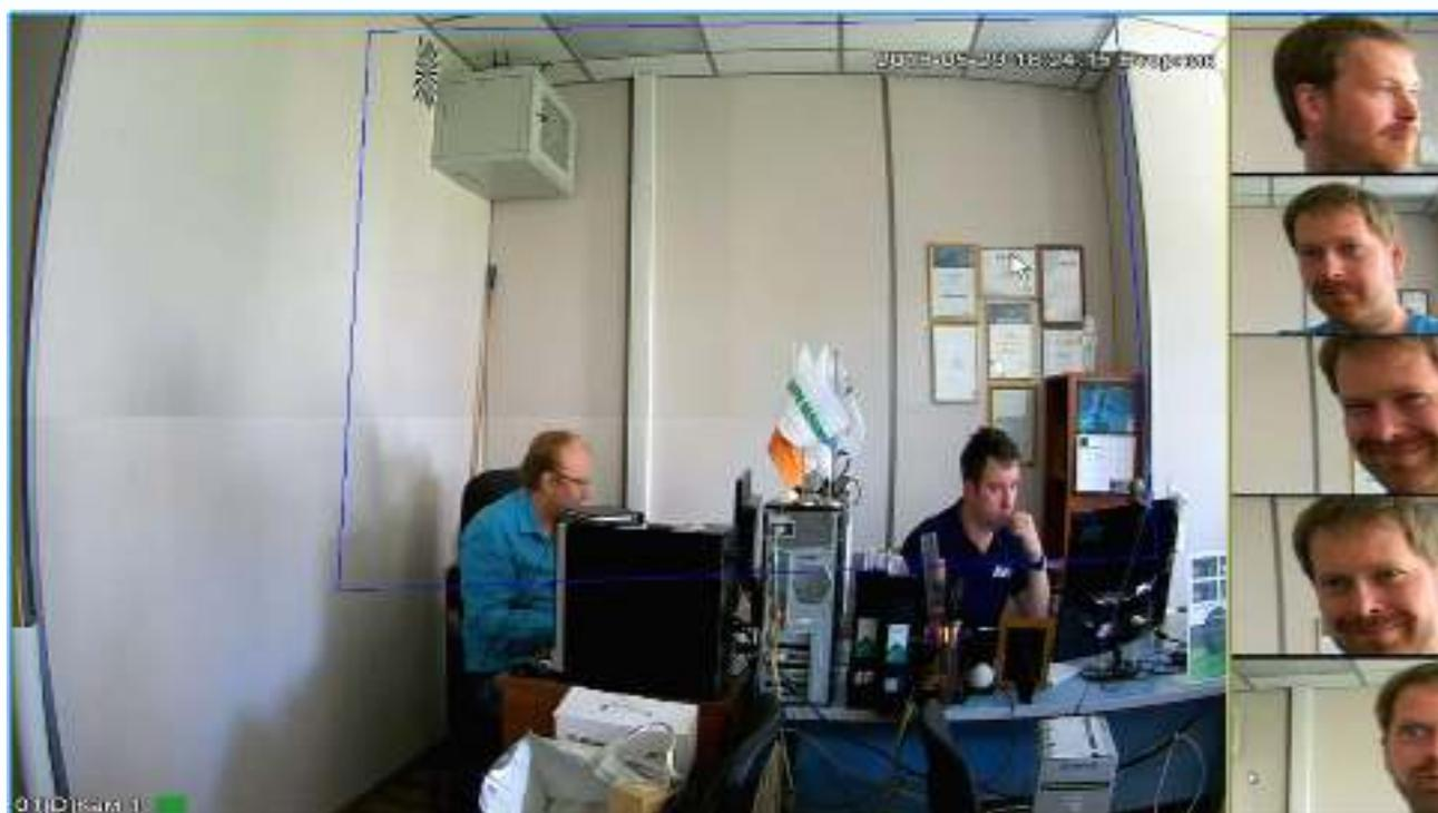
Данная функция активна только если к выбранному каналу регистратора подключена камера с поддержкой определения лиц и данная функция включена в настройках аналитики регистратора.
