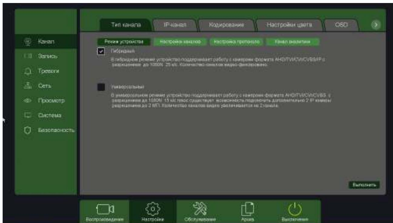
Этот пункт меню присутствует в некоторых моделях гибридных UVR и позволяет переключить режим работы регистратора – либо HD режим работы с поддержкой только HD камер и 25 к/с на каждый HD канал или гибридный режим работы, т.е. совместная работа HD и IP камер, но 15 к/с на HD канал.
