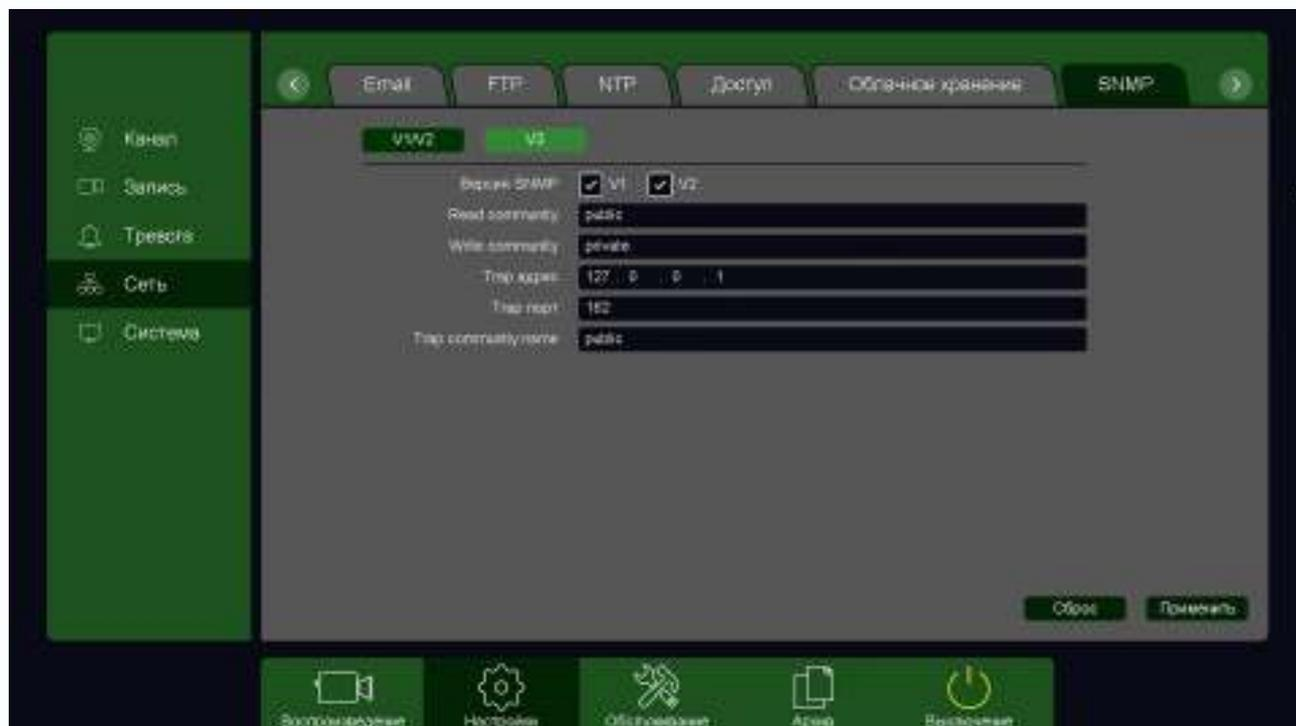
**SNMP** (Simple Network Management Protocol) — протокол, который используется для управления сетевыми устройствами. С помощью протокола SNMP, программное обеспечение для управления сетевыми устройствами может получать доступ к информации, которая хранится на управляемых устройствах (например, IP камере или видеорегистраторе).
