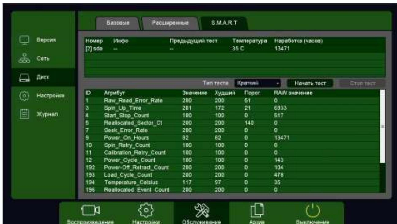
**S.M.A.R.T.** (от англ. **self-monitoring, analysis and reporting technology** — технология самоконтроля, анализа и отчетности) — технология оценки состояния жесткого диска встроенной аппаратурой самодиагностики, а также механизм предсказания времени выхода его из строя.
