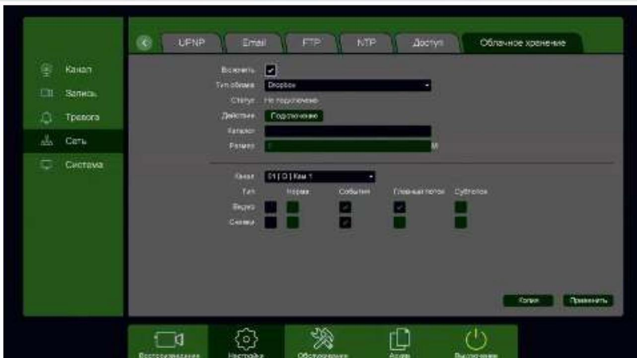
Для синхронизации с Dropbox поставьте галочку **Включить**, выберите **Тип облака** – **Dropbox** и нажмите кнопку **Подключение**.
