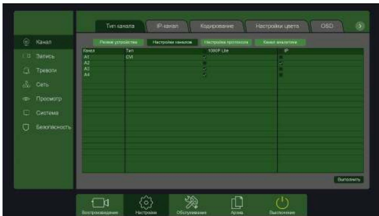
В данном меню производится выбор типа каналов – IP или HD. В зависимости от модели регистратора каналы могут переключаться из HD в IP по 1, 2, 4 или 8 каналов одновременно. Т.е., например, если в 8 канальном регистраторе переключение HD в IP производится по 4 канала, то при переключении канала 3 в IP канал одновременно в IP канал переключаются еще и каналы 1, 2 и 4.
