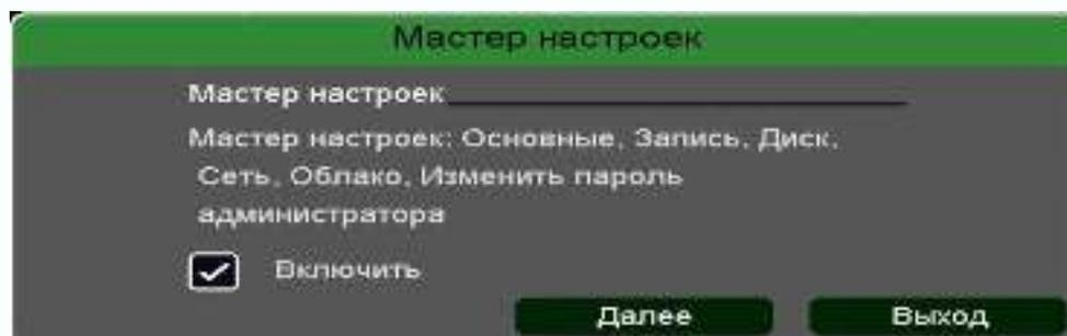
Мастер настроек автоматически запускается при включении регистратора, для отмены запуска мастера настроек снимите галочку **Включить**. Для отмены запуска мастера настроек после перезагрузки снимите галочку **Мастер настроек** в меню **Основные**.
