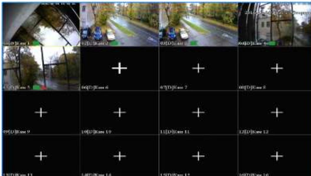
Для настройки расположения отображения камер просто перетащите окно отображения камеры в нужную позицию на экране монитора.
