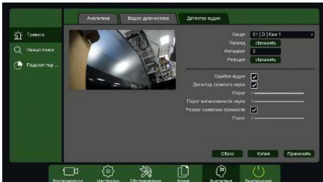
**Канал** – выбор канала, для которого производится настройка детектора аудио.
