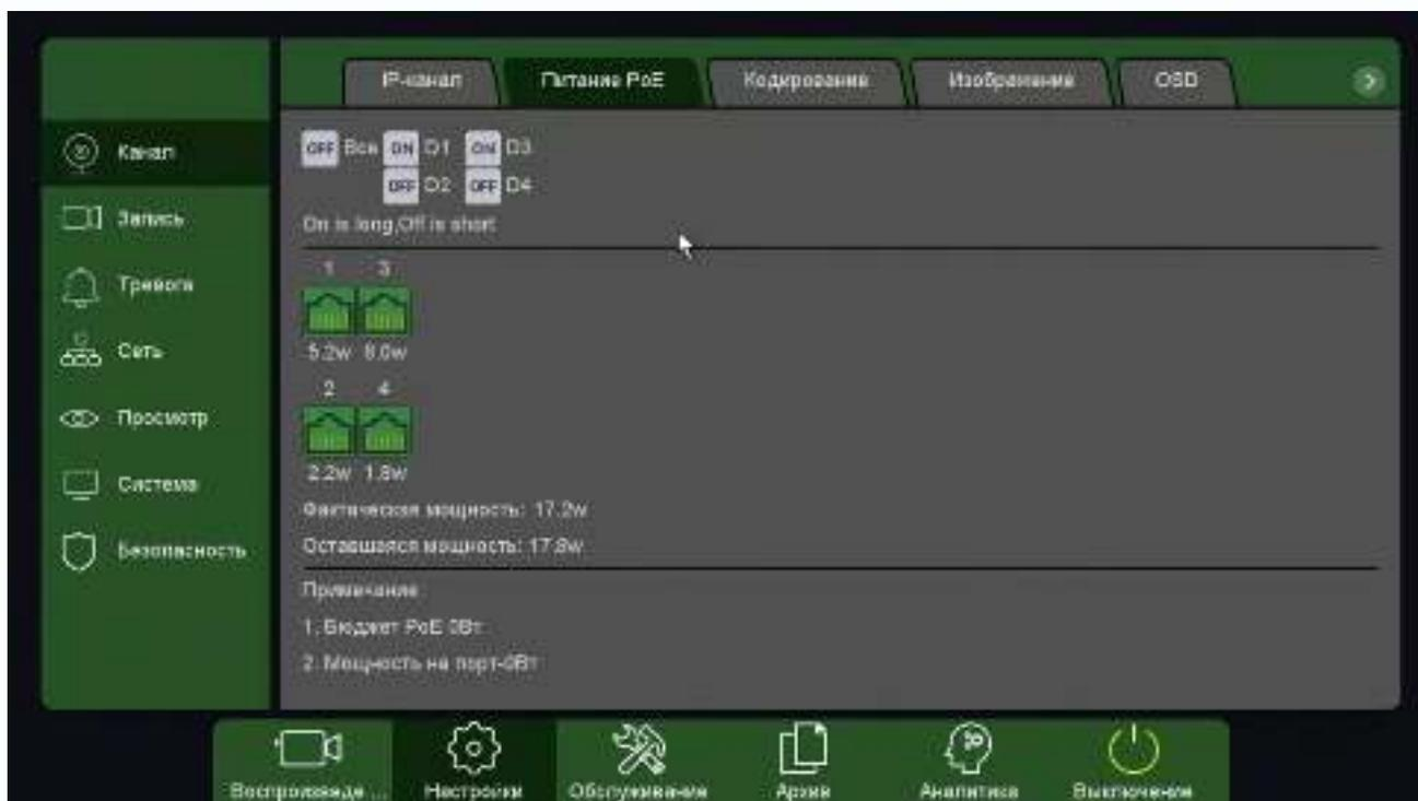
В верхней части экрана находятся иконки портов коммутатора и регистратора, каждый порт можно переключить либо в стандартный режим работы 100 Мбит/с с дальностью кабеля до 100 метров, либо в режим работы повышенной дальности (до 250м) со скоростью 10 Мбит/с. Ниже находятся иконки портов с фактической потребляемой мощностью каждого PoE порта, общая потребляемая мощность и оставшаяся доступная мощность. При превышении допустимой мощности камеры начнут отключаться начиная с последней.
