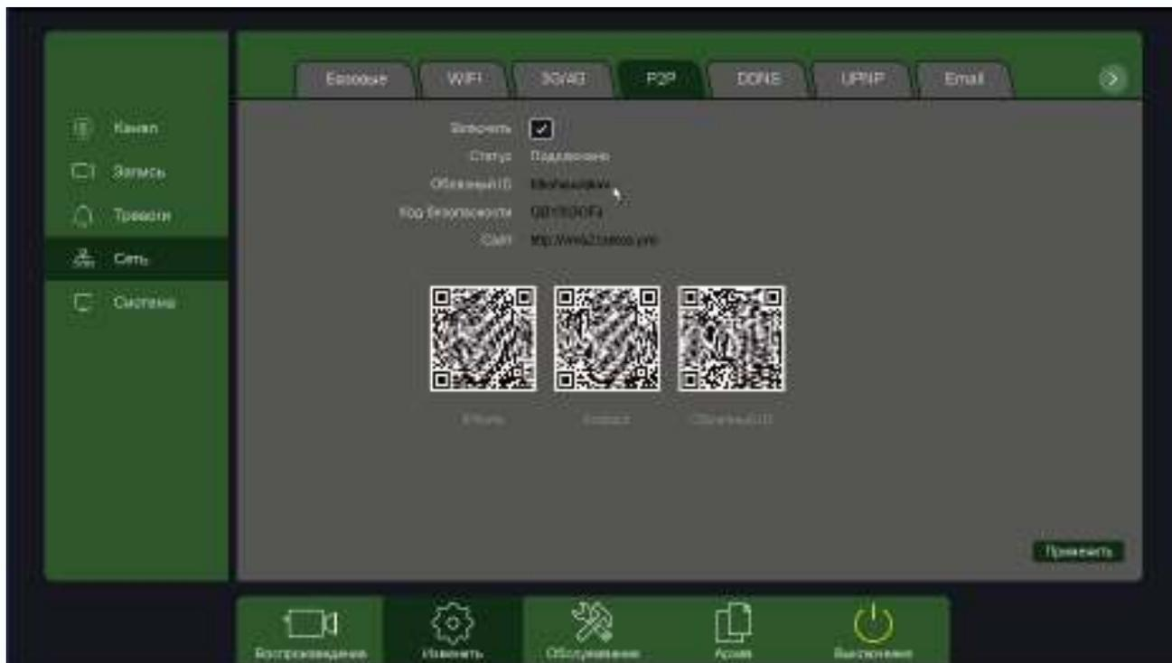
При включении этой функции видеорегистратор автоматически устанавливает соединение с сайтом <http://vms2.tantos.pro>. При этом не требуется никаких настроек роутера, связанных с пробросом портов и наличием выделенного IP адреса.
